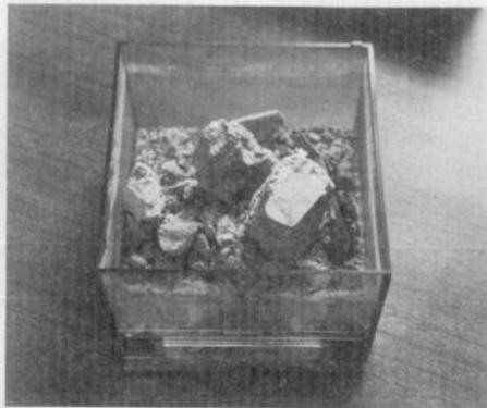
Foto 9. — Bloque caliza de Xert, 8 cm de arista, a los 50 ciclos.
