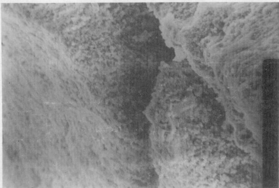
Foto 5.—Fotomicrografía de la caliza de Xert (x 500). Detalle de una microgrieta.
