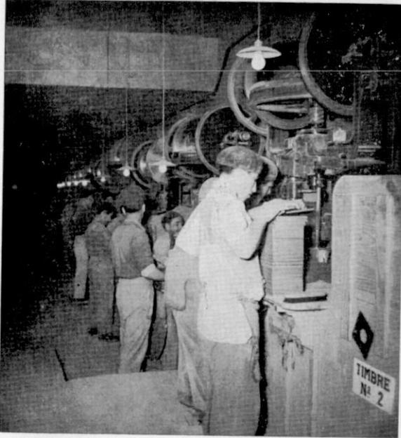
Figura 1.—Prensas mecánicas de «husilla a fricción».
