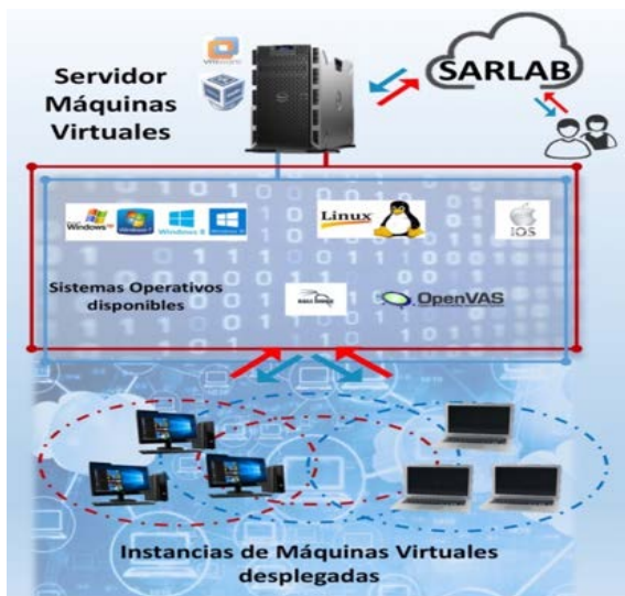
Fig. 3. Esquema despliegue máquina virtuales
