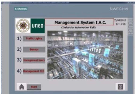
Fig. 8. Utilidades programadas en HMI. Tras la correspondiente verificación de las credenciales, se accede a las posibilidades de administración de los procesos creados en IAC-1, mostrado en la Figura 8.
