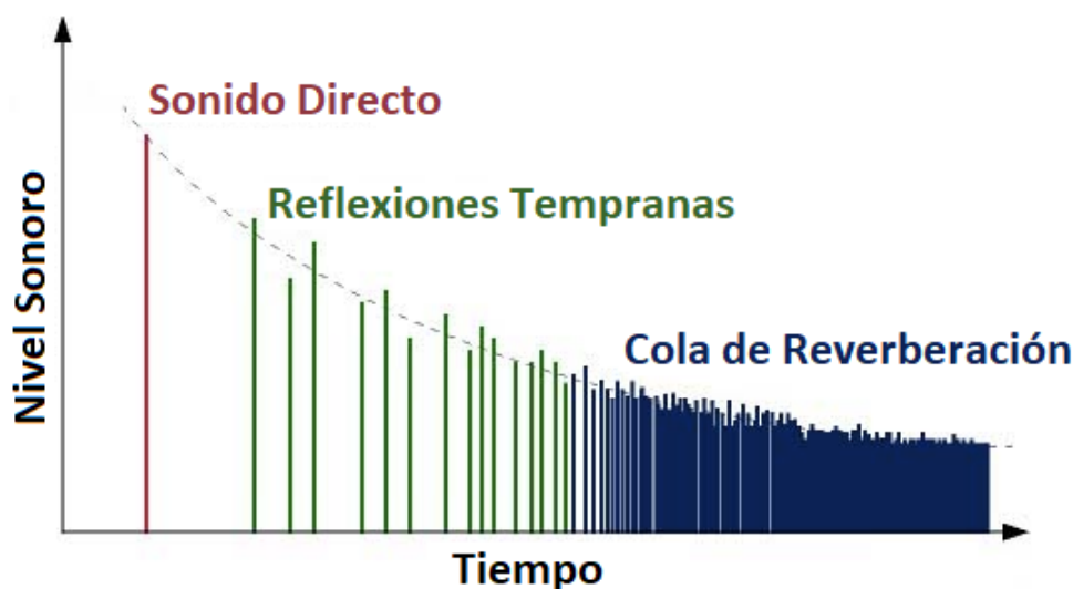
Figura 6: Diagrama de funcionamiento de la respuesta impulsiva de un entorno cerrado
