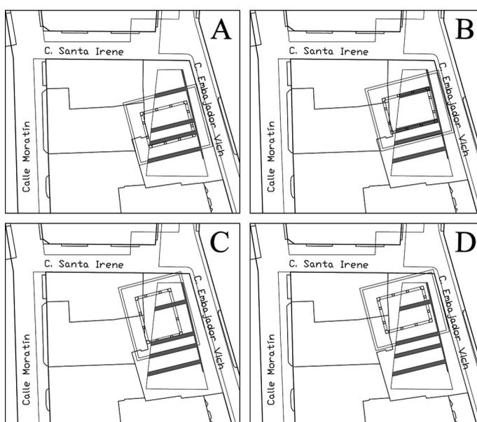
Fig. 5. Localización de las cimentaciones halladas en 1999 y superposición del patio: A) Posición del patio, considerando los cimientos bajo los muros de carga. B) Propuesta alternativa, considerando los cimientos bajo las columnas del patio. C) Tanteo de cimientos con retranqueo de la fachada. D) Tanteo de cimientos con patio adosado a la esquina y alineación actual.
